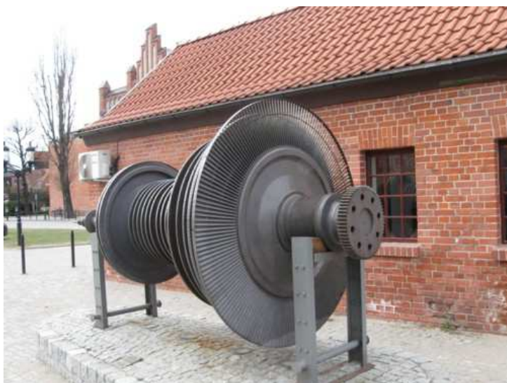
14. Fragment turbiny z dawnej elektrociepłowni
